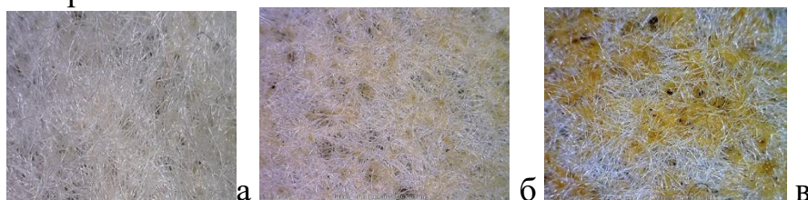
Рисунок 2 – Микрофотографии композиционных материалов со степенью пропитки 0,017 (а), 0,20 (б) и 0,45 (в)
