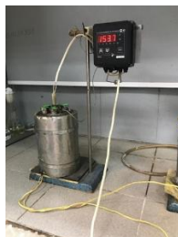
Рисунок 1 – Гидролизер капсульного типа с металлическим тепловым
